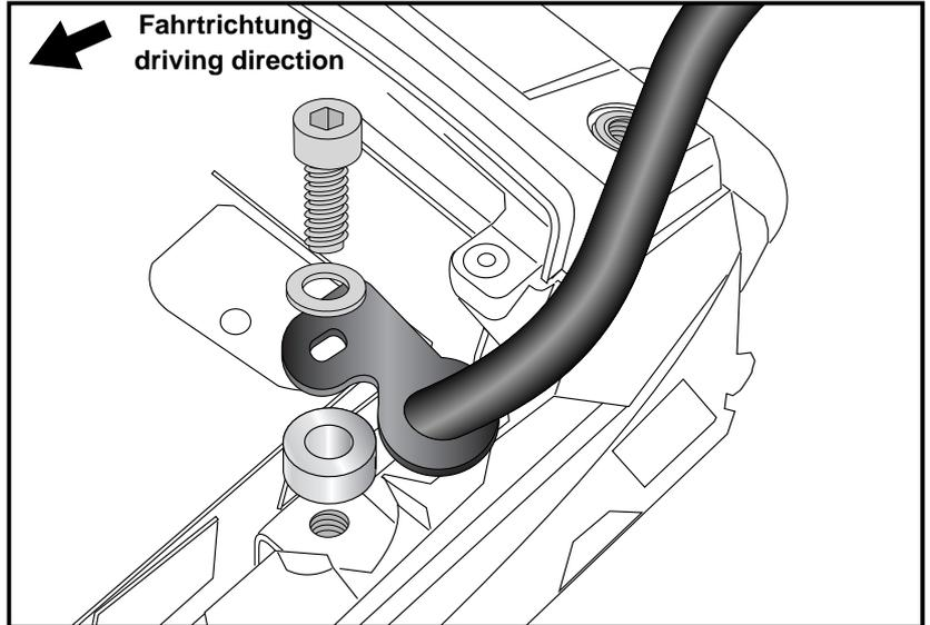
Montage der Rohradapter links und rechts hinten:
